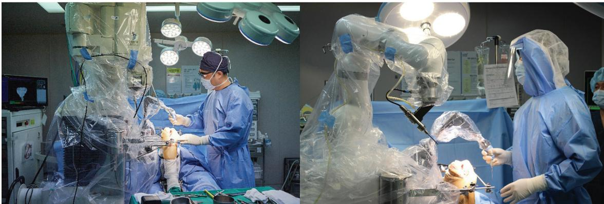
사진1. (좌)로보닥, (우)닥터 엘씨티를 이용한 인공관절 수술
